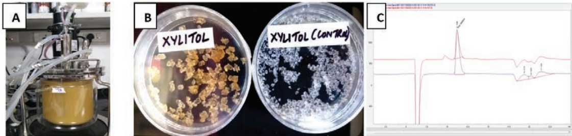
चित्र 7: सिंथेटिक जाइलोज़ युक्त मीडिया के साथ ऑपरेशन में ए, 3 एल लैबस्केल किण्वक दिखा रहा है। बी, क्रिस्टलीकृत जाइलिटोल। सी, क्रिस्टलीकृत जाइलिटोल और नियंत्रण के एचपीएलसी क्रोमैटोग्राम।
